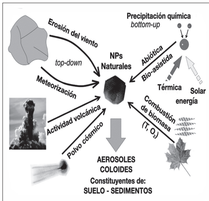
FIGURA 24 PROCESOS NATURALES CONDUCTENTES A LA FORMACIÓN DE NANOPARTÍCULAS EN EL MEDIO (NPS – NANOPARTÍCULAS NATURALES; T – TEMPERATURA; O 2 -OXÍGENO) (SHARMA ET AL., 2015)
