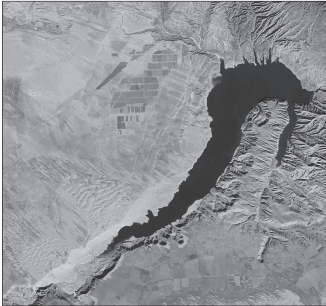
FIGURA 8 IMAGEN DE SATÉLITE DE LA PLANTA FV LONGYANGXIA DAM SOLAR PARK (CHINA), DE 850 MW, UBICADA JUNTO A UNA CENTRAL HIDRÁULICA DE 1.280 MW.
