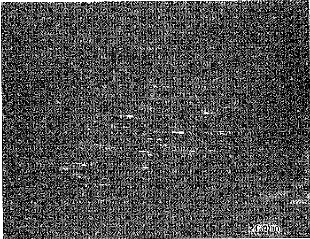
FIGURA 5 PARTÍCULAS TETRAGONALES EN EL SISTEMA MgO-ZrO 2 TRANSFORMADAS A MONOCLÍNICAS AL PASO DE UNA FISURA QUE SE CIERRA
