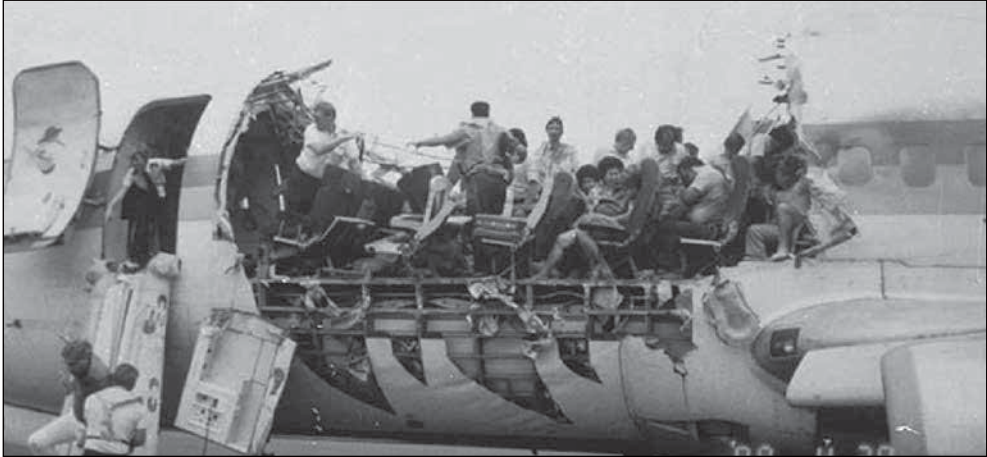
FIGURA 15 ESTADO EN QUE QUEDÓ EL AVIÓN ACCIDENTADO DE LA COMPAÑÍA ALOHA EN 1988 DESPUÉS DEL ACCIDENTE
